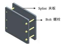
Fig. 1 Diagram of cell clamp 图 1 夹具示意图
