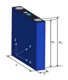
Fig.6 Diagram of LF125Cell direction 图 6 LF125 电池方向示意图
