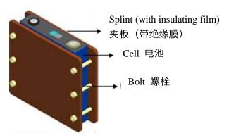
Fig. 4 Diagram of cell with clamp 图 4 电池上夹具图
